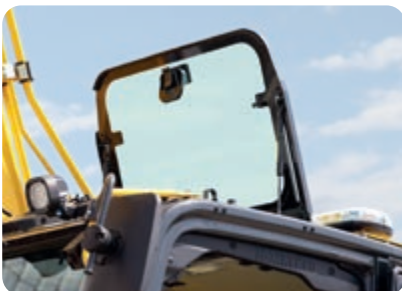
Neues, aufklappbares Dachfenster aus Polycarbonat mit Sonnenschutzrollo
