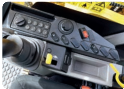
Auf der rechten Konsole gruppierte Schalter für optimalen Zugriff
