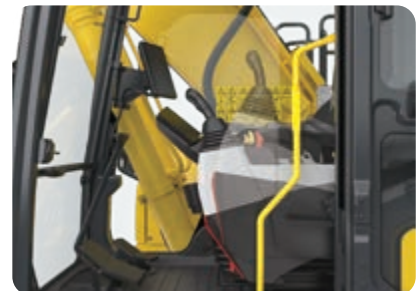
Hochklappbare Seitenkonsole für einen sicheren und bequemen Zugang
