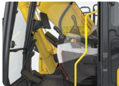
Console latérale relevable pour plus de sécurité et de confort en entrant et en sortant
