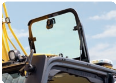
Nouveau hayon de toit ouvrable en polycarbonate avec store pare-soleil à enroulement
