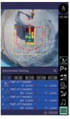
Le impostazioni di comando degli accessori sono accessibili e regolabili rapidamente mediante un unico pulsante di scelta rapida, consentendo una configurazione rapida e precisa.
