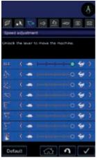
Le impostazioni delle attrezzature di lavoro sono facilmente accessibili e regolabili tramite comandi a cursore, personalizzati in base alle specifiche applicazioni e alle preferenze dell'operatore.
