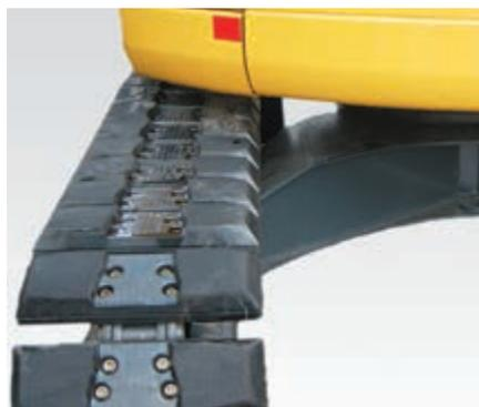
600 mm Gummibodenplatten (Roadliner) (optional)
