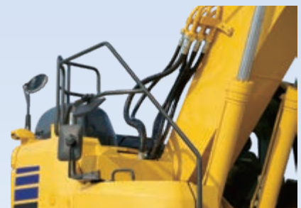
Handläufe und rutschfeste Oberflächen
