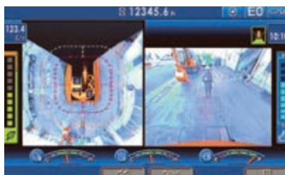
Con el sistema KomVision, sistema de cámaras trasera y laterales con vista de pájaro 360°
