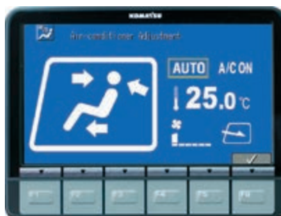
Aire acondicionado automático
