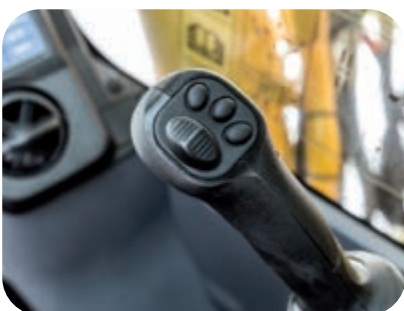
Un control práctico, ergonómico y preciso: joysticks con botón de control proporcional para implementos
