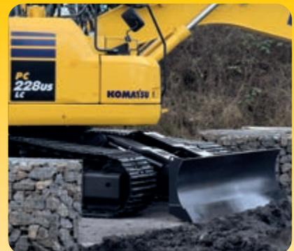
Lame (en option) pour patins acier triple arête et patins road liner (caoutchouc) de 600 mm
