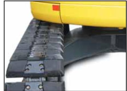
600 mm Gummibodenplatten
