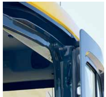
Die Schiebetür ist der abgerundeten Kabinenform angepasst und somit perfekt gegen Beschädigungen geschützt. Sie ist weiterhin mit einem Schiebefenster ausgestattet.
