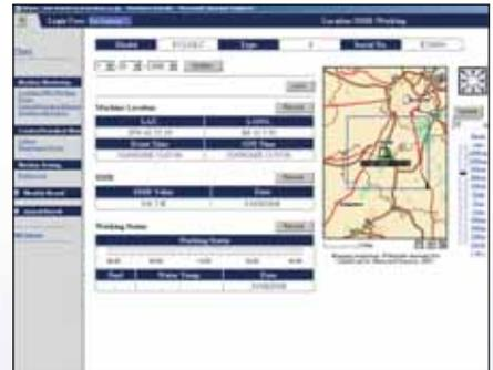
Sicurezza totale – La funzione “Blocco motore” permette di programmare quando il motore di una macchina può essere acceso. In più con “geo-fence” KOMTRAX™ invia un messaggio di notifica ogni volta la macchina entra od esce da una area operativa predefinita.
