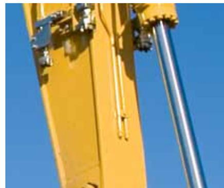
*Linee idrauliche attacco rapido (di serie)*
