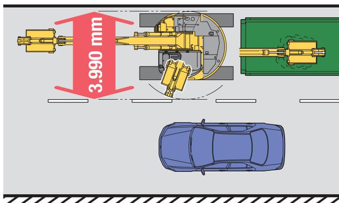
Quando si eseguono lavori stradali, la sporgenza della macchina sulla corsia libera è ridotta al minimo. Questo consente di posizionare un camion più vicino al cingolo della macchina.
