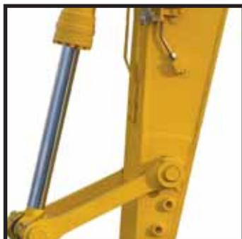
Linee idrauliche attacco rapido (di serie)
