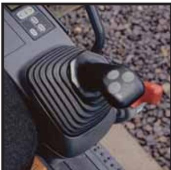
Hebel mit 3 Schaltern
