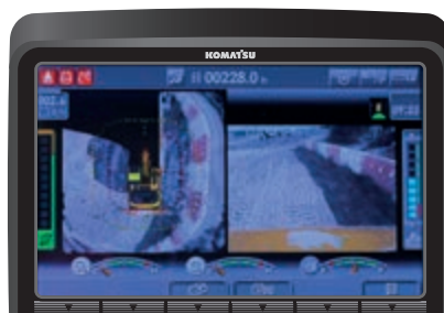
Via KomVision zijn verschillende camerazichten beschikbaar, maar met behoud van permanent "vogelperspectief" van boven de machine
