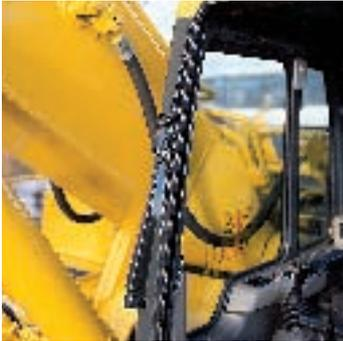
Der Überblick nach vorne wird weiterhin durch die Verwendung von Komatsus patentiertem Scheibenwischer-system verbessert. Wird der Scheibenwischer nicht gebraucht, ruht er im Kabinenrahmen selbst, ohne irgendeinen Kontakt mit der Frontscheibe. Dieses System bietet neben einem ausgezeichneten Überblick zugleich eine Abschaltung des Scheibenwischers, bevor die Frontscheibe angehoben wird.
