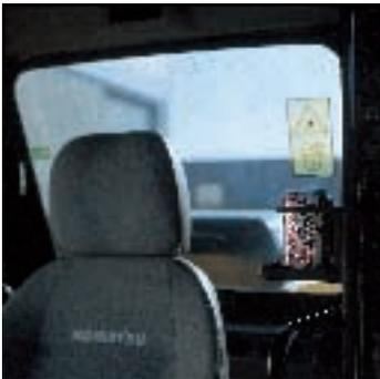
Die neue, sichere Getränkeablage ist innerhalb der Reichweite des Maschinenführers platziert.
