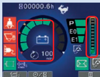
Batteriestatus und aktueller Energieverbrauch (Eco-Anzeige)
