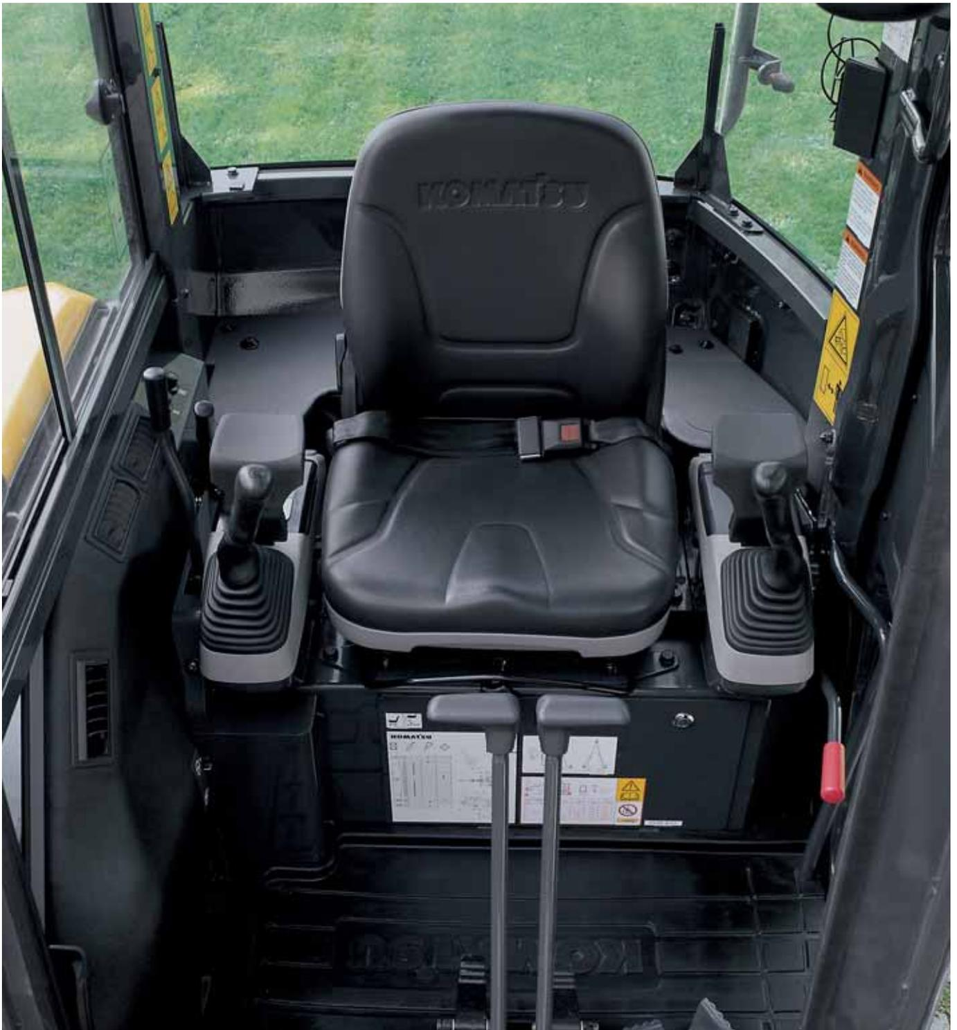
Ein sorgfältig und bis ins kleinste Detail durchdachtes Fahrerhaus: Ergonomisch angeordnete PPC-Bedienelemente, eine automatische Fahrstufenwahl anstelle eines Pedals im Fußraum, ein komfortabler Fahrersitz und optimale Sicht in alle Richtungen bieten dem Fahrer maximalen Komfort. Das innovative Design der Schiebetür schützt vor Beschädigung auch im beengten Einsatz und sichert einen bequemen Ein- und Ausstieg in das Fahrerhaus.
