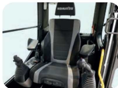
Premiumsäte som tillbehör, med stoppning av högsta kvalitet, automatisk viktjustering, stöd för korsryggen, automatisk klimatanläggning, tillgänglig med tillbehören flerpositionsarmstöd och ergonomiska manöverspakar
