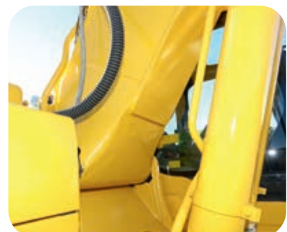
Gjuten bommens fot och hela bomplåtar
