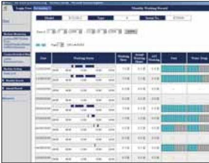
*Ore di esercizio macchina – Con lo “storico giornaliero sulle ore di esercizio” potete avere i tempi precisi di utilizzo della macchina; sia quando il motore è stato acceso e spento, sia il tempo effettivo di esercizio.*
