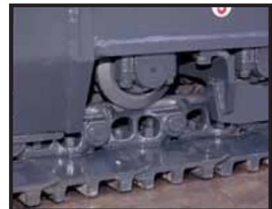
Beim PC290-7 kommen verstärkte Kettenlieder mit Mittelsteg zum Einsatz.
