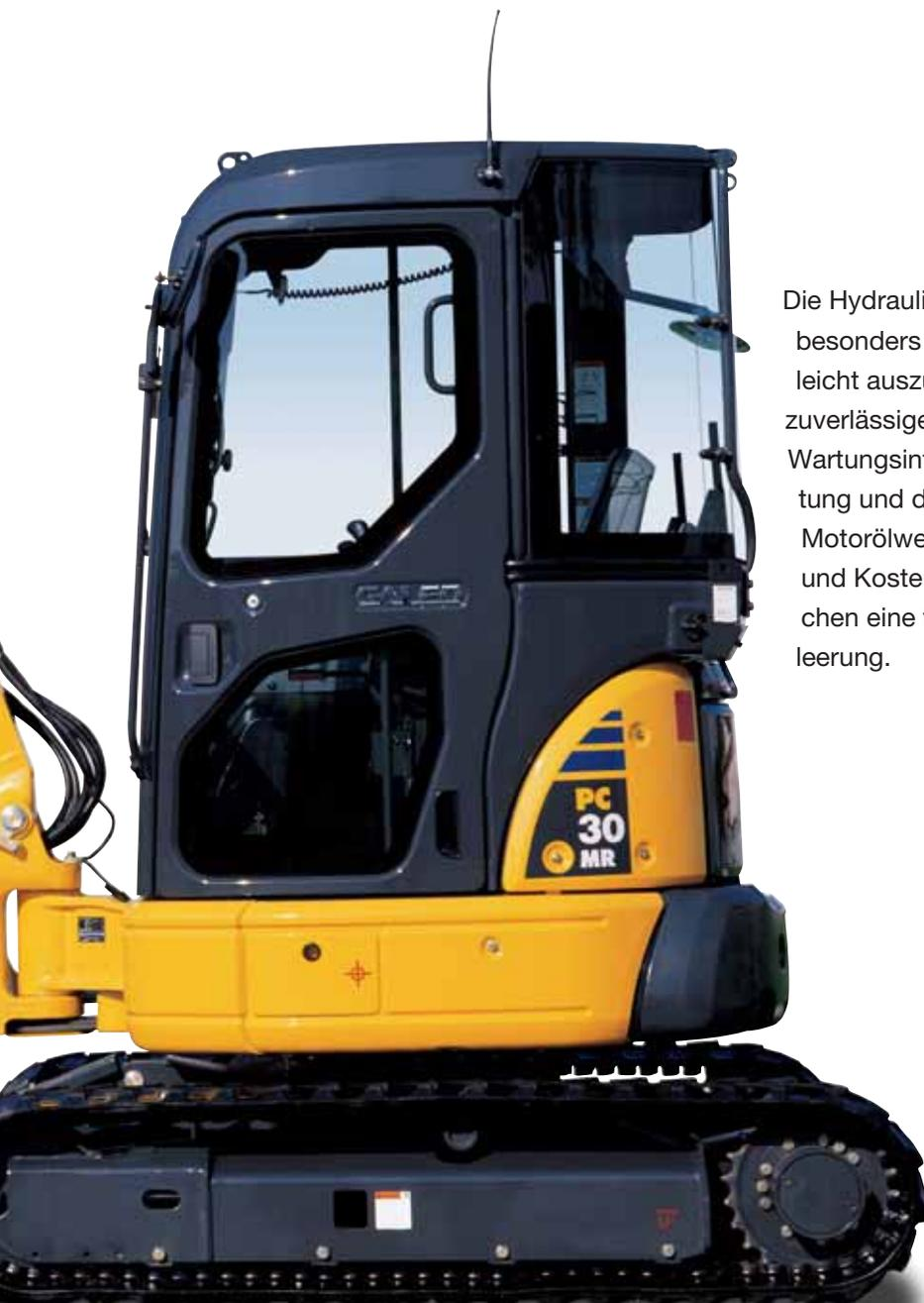
Die Hydraulikleitungen sind dank ORFS-Kupplungen besonders gegen Leckage geschützt und bei Bedarf leicht auszuwechseln. DT-Steckverbinder sichern zuverlässige Verbindungen für die Elektrik. Ein 500 h Wartungsintervall für die Buchsen der Arbeitsausrüstung und das Schwenkwerk sowie ein verlängertes Motorölwechselintervall reduzieren Stillstandzeiten und Kosten. Ablassschläuche an den Tanks ermöglichen eine tropffreie und umweltverträgliche Tankentleerung.
