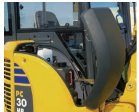
Vordere Wartungsklappe: leichtes Betanken
