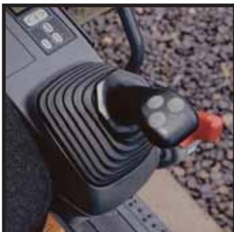
Hebel mit 3 Schaltern
