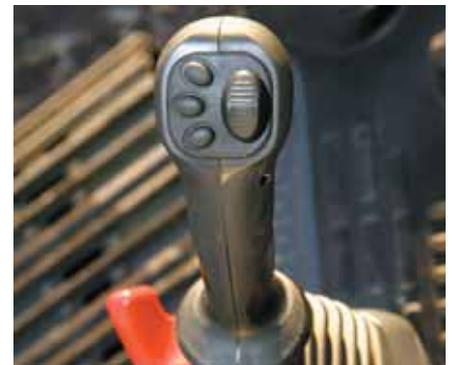
Joysticks mit Proportionalsteuerung für Anbaugeräte
