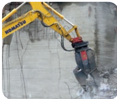
Dos líneas hidráulicas opcionales para montar una variedad de implementos
