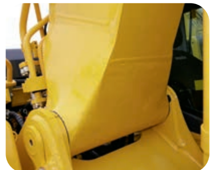
Gegoten giekvoet en giekplaten uit één stuk
