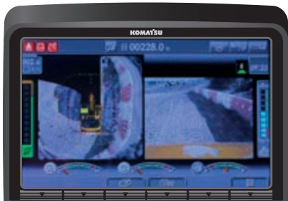
Med KomVision finns flera kameravinklar att välja mellan, tillsammans med "helikopterperspektivet" ovanifrån
