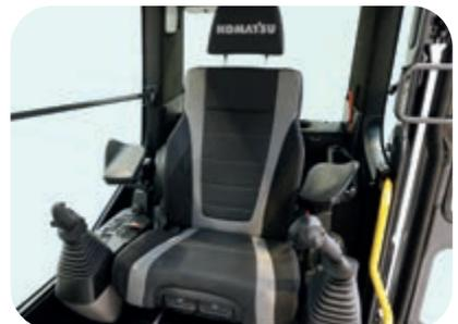
Siège premium en option, avec une assise de grande qualité, réglage automatique du poids, soutien lombaire, climatisation, et possibilité d'accoudoirs repositionnables et de leviers de commande ergonomiques
