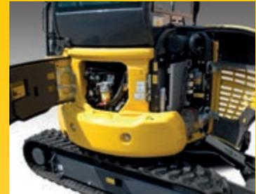
Hintere Wartungsklappen für schnelle Motorinspektion und Betankung, einfachen Wartungszugang, leichte Reinigung der Kühler und guten Zugang zur Batterie
