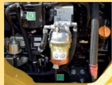
Der große Kraftstofffilter und der Kraftstoffvorfilter mit Wasserabscheider schützen den Motor
