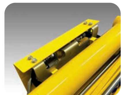
Slangbrottsventiler på bomcylinder och stickcylinder
