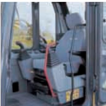
Die neue, optionale Heizung des luftgefederten Sitzes ist speziell für Maschinenführer gedacht, die über viele Stunden in kaltem Klima arbeiten müssen.
