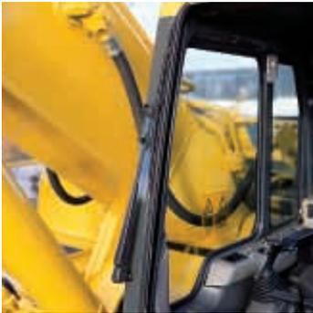
Visibilità anteriore migliorata dal tipo di tergicristallo brevettato dalla Komatsu. Quando non viene usato, il tergicristallo si posiziona sul montante della cabina, senza contatto con il lunotto anteriore. Oltre a dare un'eccellente visibilità, questo sistema evita la necessità di scollegare il tergicristallo prima di sollevare il lunotto anteriore.
