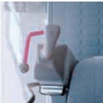
A richiesta, 4 pulsanti cablati per il controllo di attrezzature opzionali, vengono installati al momento della fabbricazione. I cavi sono integrati nel sistema elettrico standard, garantendo la possibilità di estendere in modo rapido e sicuro la funzionalità della macchina. Le leve di comando sono in posizione ergonomica.
