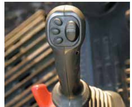
Joysticks mit Proportionalsteuerung für Anbaugeräte
