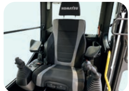
Optionele topcomfortstoel met kussens van topkwaliteit, automatische aanpassing aan het gewicht, lendesteun en klimaatregeling, beschikbaar met optionele instelbare armleuningen en ergonomische bedieningshendels
