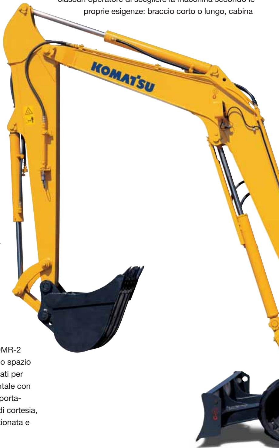
o tettuccio, cingoli in gomma o in acciaio, con o senza zavorra addizionale. Inoltre, la linea idraulica ausiliaria, a 1 o 2 vie, permette di utilizzare molteplici attrezzature, quali ad esempio il martello, la benna mordente, la trivella, etc.
