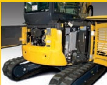
Hinteren Wartungskappen für schnelle Motorinspektion und Betankung, einfachen Wartungszugang, leichte Reinigung der Kühler und guten Zugang zur Batterie
