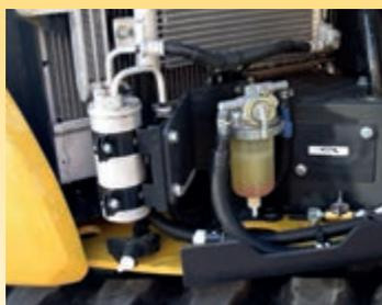
Der große Kraftstofffilter und der Kraftstoffvorfilter mit Wasserabscheider schützen den Motor.
