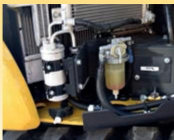
Grands filtre et pré-filtre à carburant avec séparateur d'eau pour protéger le moteur
