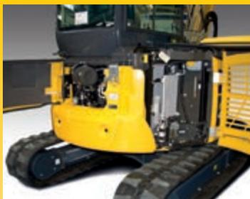
Capots arrières pour contrôle rapide des éléments du moteur, simple inspection et nettoyage des radiateurs et accès facilité à la batterie
