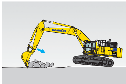
„Power“-Betriebsart Der Ausleger verfügt über höchste Grab- und Eindringkräfte.
