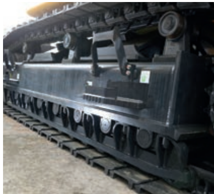
Laufrollenschutz über die gesamte Laufwerkslänge (Option)
