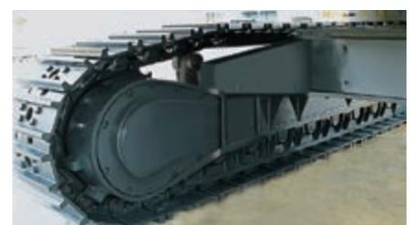
Robuster Schutz der Fahrmotoren
