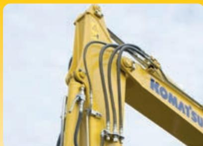
Ligne hydraulique auxiliaire simple ou double effet pour les accessoires et ligne hydraulique pour l'attache rapide
