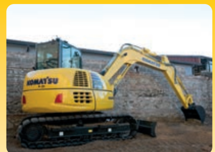
Med reducerad främre svängradie görs dikesgrävningen till en enkel sak även i trånga utrymmen
