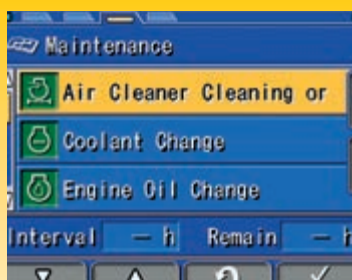
Flerfunktions-instrumentpanel ger föraren enkel tillgång till underhålls- och serviceinformation
