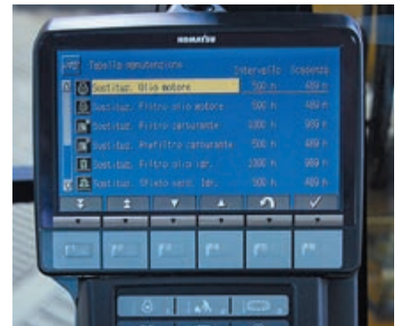
Der LCD-Monitor zeigt Unregelmäßigkeiten und Wartungsintervalle an
