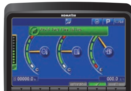
Indicatore Eco, guida Eco, avviso di motore al minimo ed un spegnimento automatico regolabile in caso di inattività per ottimizzare ulteriormente il consumo di carburante
