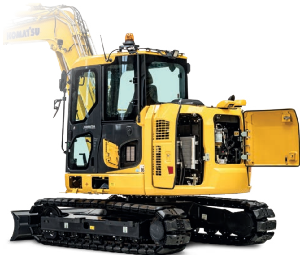
Alla större underhållspunkter kan enkelt nås från marknivå
