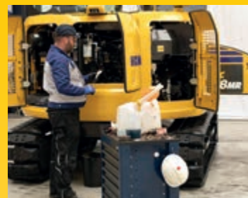
Alla större underhållspunkter kan enkelt nås från marknivå
