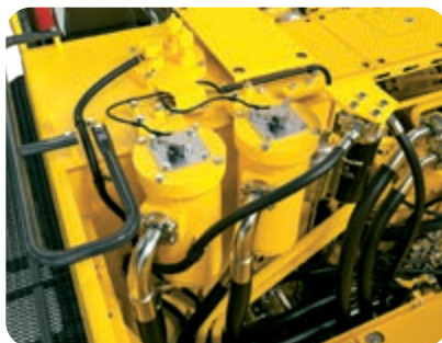
Die Funktion zur Erkennung eines verstopften Rücklauffilters zeigt an, wenn ein Austausch erforderlich ist, und verhindert Schäden am Hydrauliksystem.
