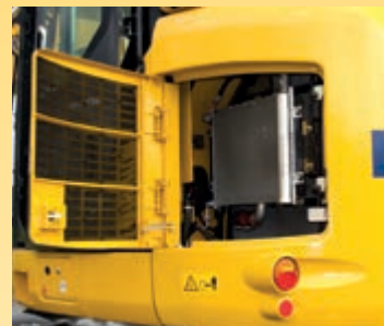
Kylarnäten är integrerade i sidoluckorna för enkel rengöring, med åtkomst från marknivå
