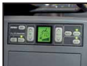
Climatisation à régulation de température
