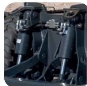
Vérins de lame/stabilisateur avec soupape de contrôle intégrée (de série)
