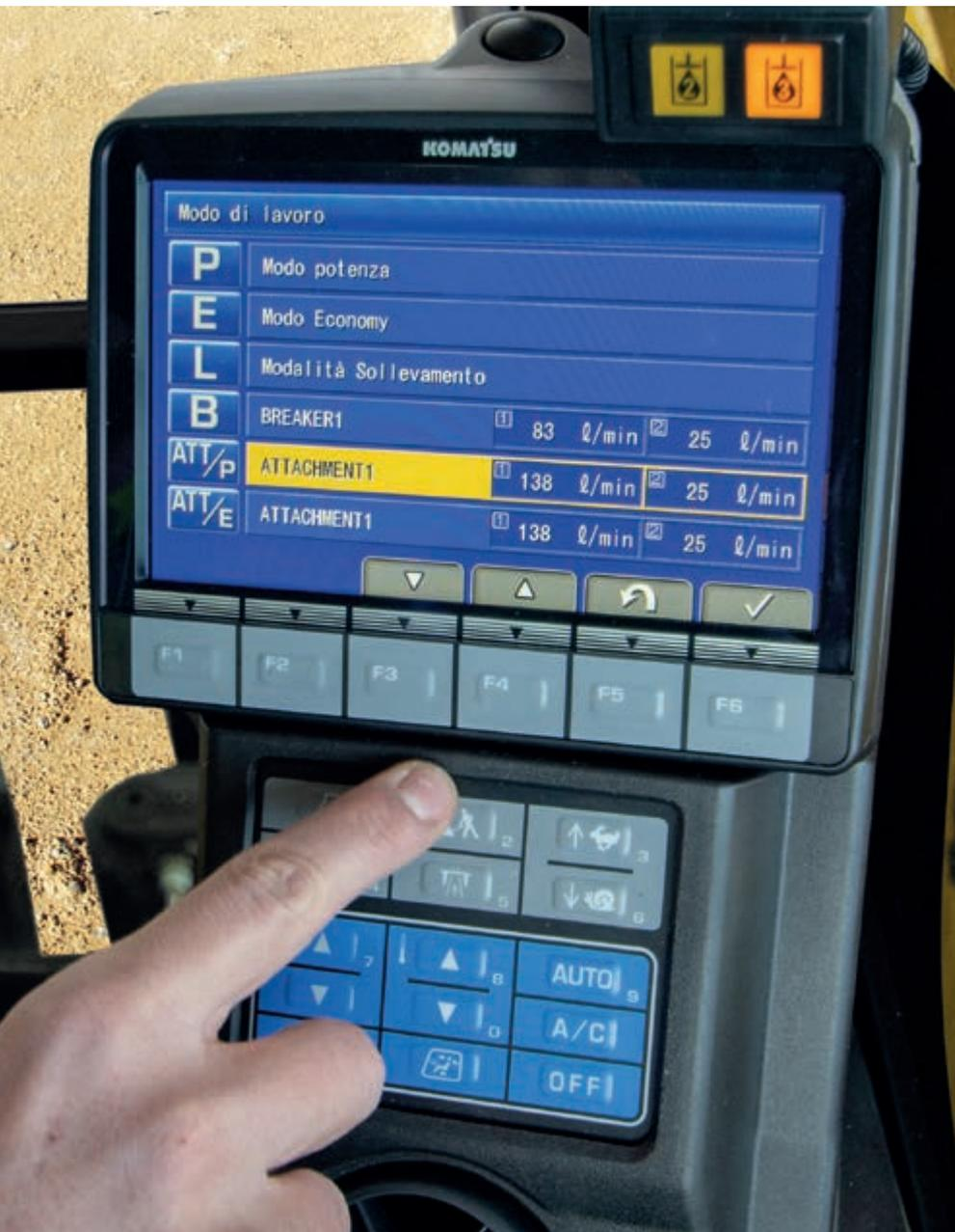
La machine dispose de raccords universels pour les accessoires tels qu'un marteau. Le passage à un mode basse pression n'exige qu'une pression sur le bouton de l'écran correspondant au mode marteau.
