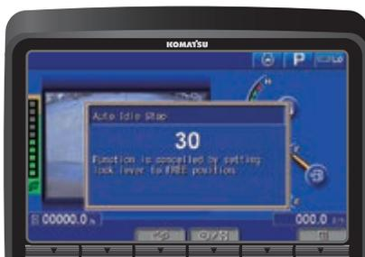
La jauge éco, les conseils éco et l'arrêt moteur automatique réglable en cas de ralenti prolongé permettent une plus grande réduction de consommation de carburant.
