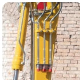
Circuit hydraulique auxiliaire supplémentaire (en option)
