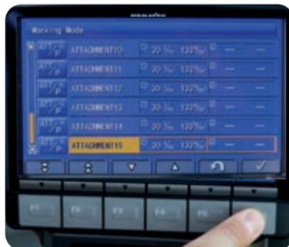
Le contrôle des accessoires intégré Komatsu (KIAC) offre jusqu'à 15 présélections d'outils pour le débit et la pression d'huile (en option)
