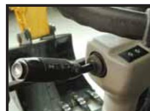
Verstellbare Lenksäule mit vielen Funktionen: Scheibenwischer, Blinker, Hupe, Scheinwerfer etc.
