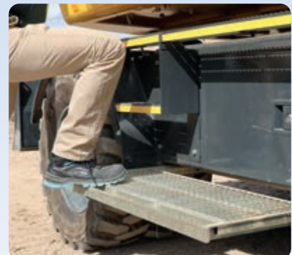
Händläufe und rutschfeste Oberflächen für bequeme und sichere Wartungseinsätze
