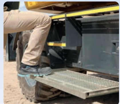
Handrails en antislipplaten voor een handige en veilige toegang tot de onderhoudspunten
